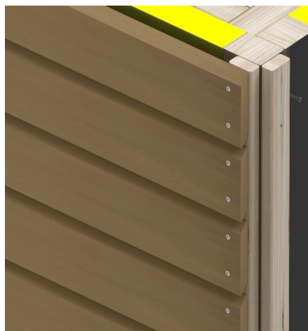
Rhombus-Profile \geq 80 mit 2 Schrauben oder Nägeln befestigen.
