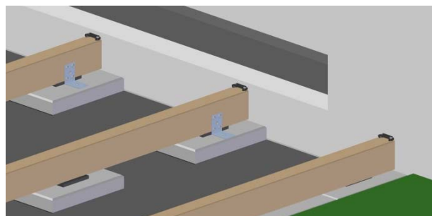
Bild 2. Halter mit allen Unterkonstruktionen verschrauben.
