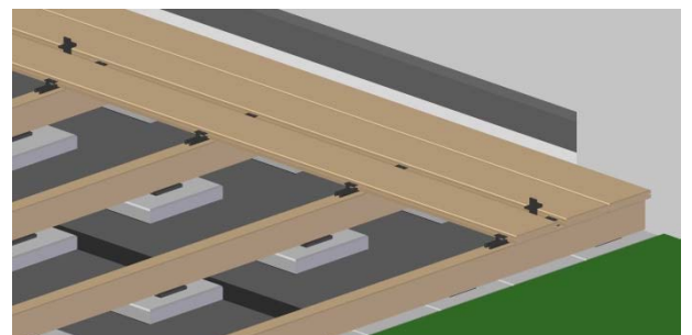
Bild 12. Alle weiteren Dielen werden genauso verschraubt.
