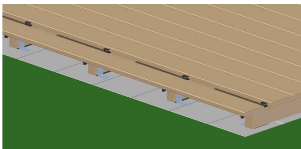
Bild 16. Diele umdrehen und auf den H-Stick schieben. 8 mm Fuge beachten.
