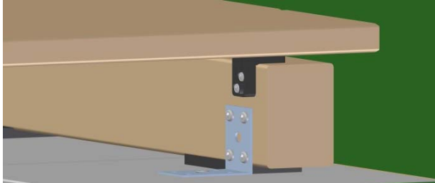
Bild 18. Montage Endclip an der Unterkonstruktion aufliegen.
