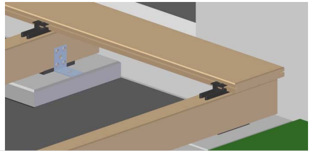
Bild 8. Je Unterkonstruktion 1 H-Stick verwenden.
