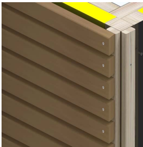
Rhombus-Profile \leq 80 mm Breite mit 1 Schraube oder 1 Nagel befestigen.
