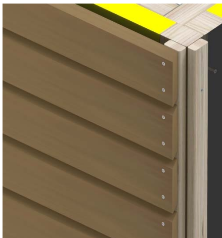
Rhombus-Profile \geq 80 mit 2 Schrauben oder Nägeln befestigen.
