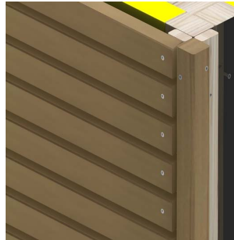
Die Enden der Profile sollten immer mit Leisten geschützt werden.
